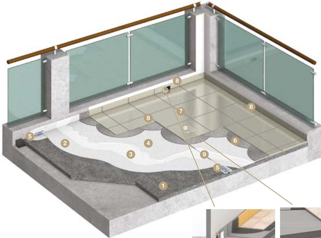
*Pour garantir un écoulement rapide des eaux de pluie, les lignes de pente au sol doivent assurer le convoyage correct vers les canalisations avec une valeur minimale d'1,5 %. Prévoir la mise en place de canalisations afin d'assurer l'écoulement régulier et aisé des eaux de pluie, sans contre-pentes ni stagnations d'eau. La gamme de systèmes d'imperméabilisation propose, au choix, des canalisations verticales ou frontales pour les Systèmes Aquazip, toutes équipées de brides armées de raccord.*
