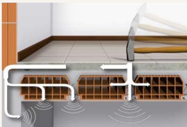
Propagation du bruit à travers la structure d'un bâtiment réalisé avec chape sans sous-couche acoustique
