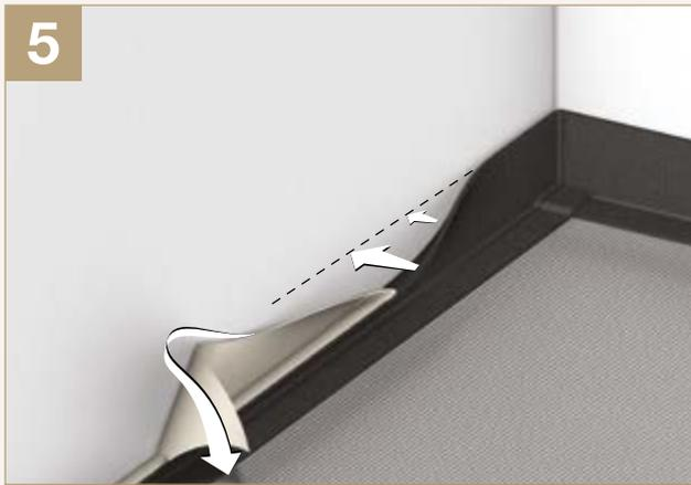
Enlever ensuite l'autre bande adhésive, celle présente sur le côté le plus long, et la coller sur la paroi. Il est extrêmement important de soigner les angles et les arêtes ; la bande adhésive doit adhérer parfaitement à la paroi de manière à faciliter la pose ultérieure du revêtement.
